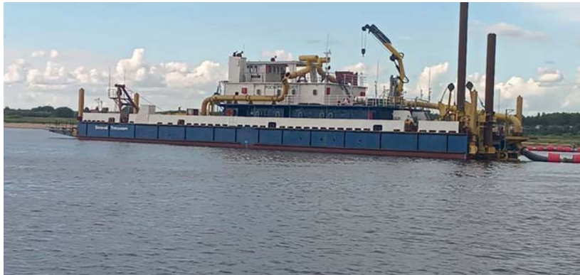
Несамостоятельный дноуглубительный землесос «Евгений Плескевич»
